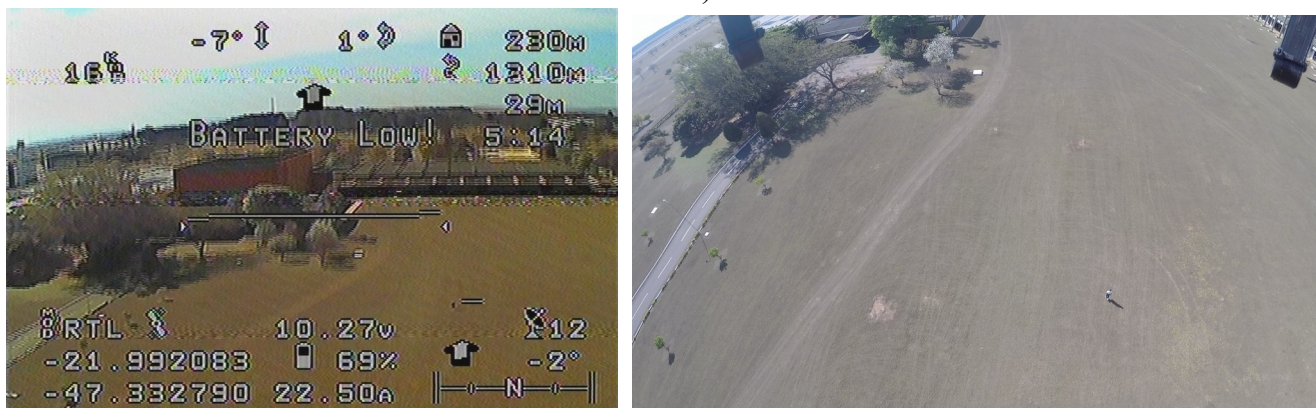
Figura 8 - comparação de resolução entre uma câmera FPV (a esquerda) e uma GoPro (a direita).
