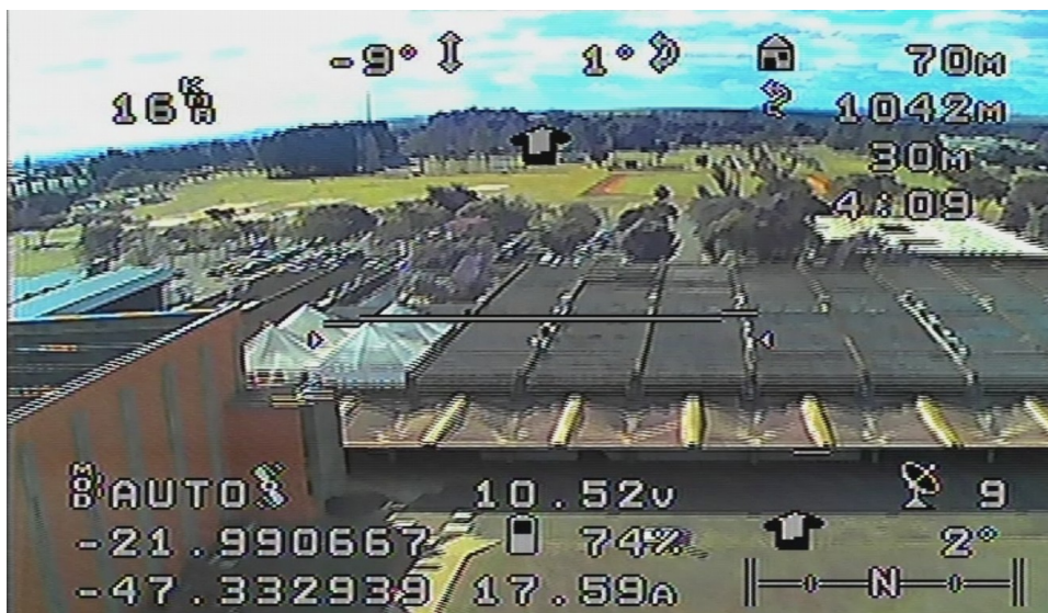
Figura 4 – Dados telemétricos em uma câmera FPV através de uma placa OSD.
