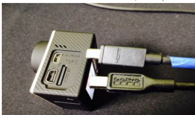
Figura 9 - As entradas existentes em uma GoPro Hero 4 , USB (em baixo) e HDMI (em cima).
