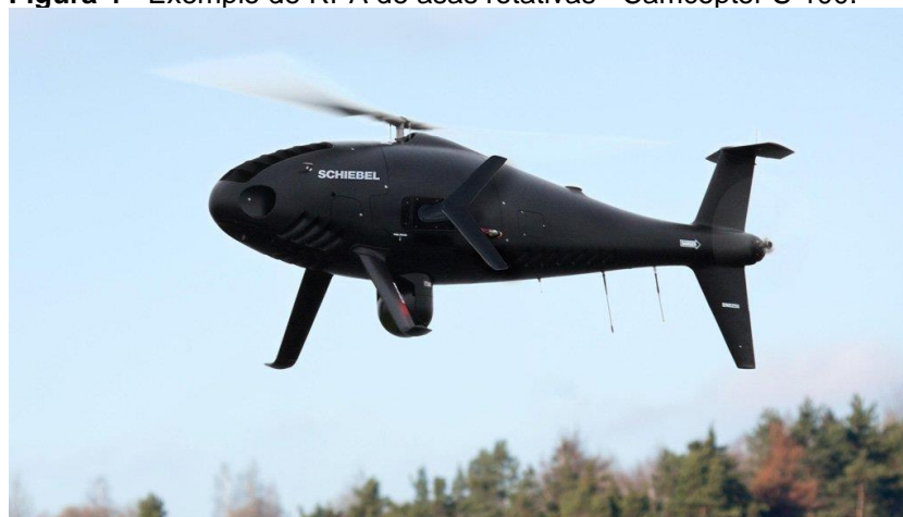
Figura 4 - Exemplo de RPA de asas rotativas - Camcopter S-100.
