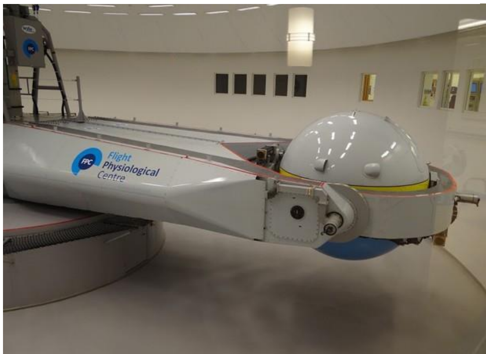
Figura 5 – Centrífuga na base de Satenas, na Suécia, testa capacidade do piloto de caça de aguentar 9 vezes a força da gravidade.
