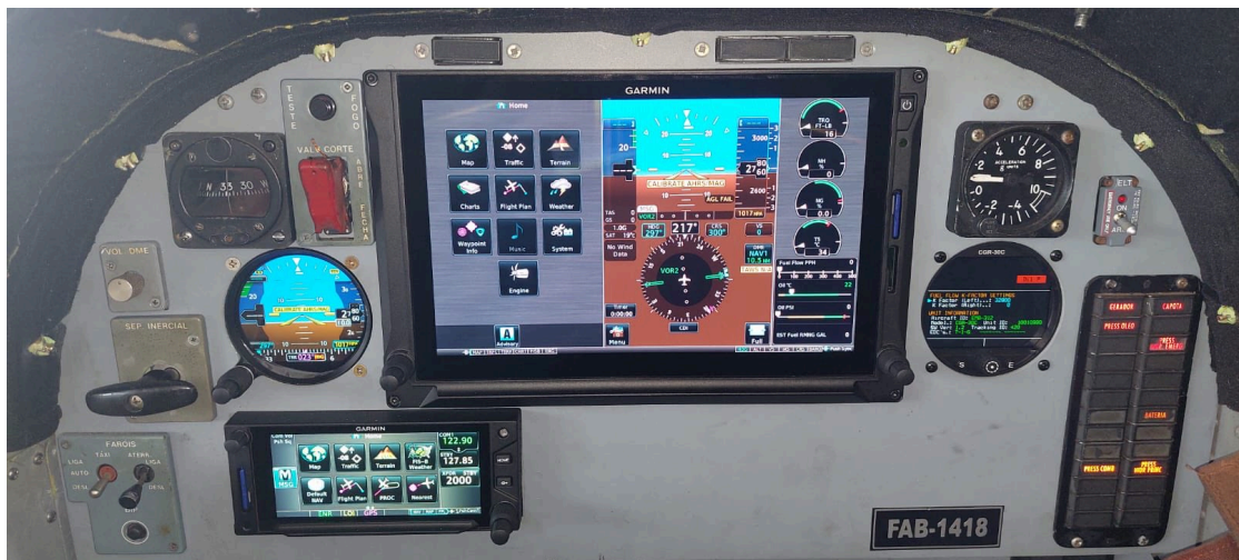
Imagem 02: Painel de instrumentos digitais ( glass cockpit ) do T-27M Tucano
