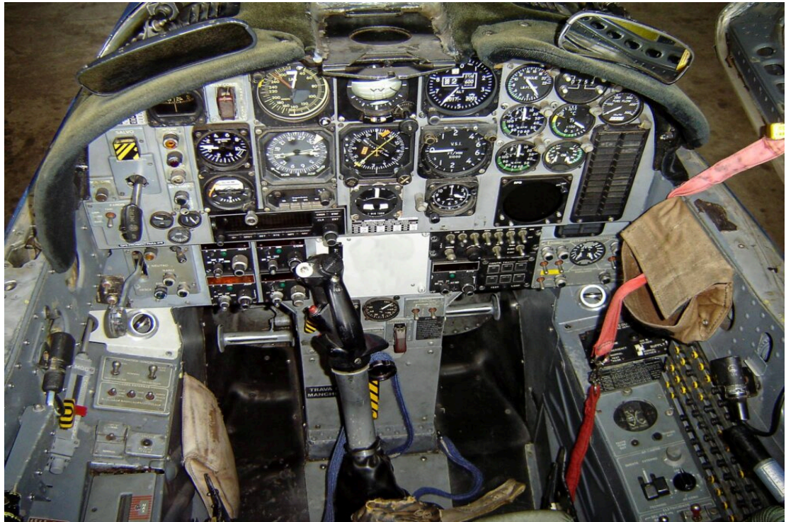
Imagem 01: Painel de instrumentos analógicos do T-27 Tucano
