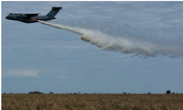
Figura 14 – KC-390 com o sistema para combate a incêndio em voo
