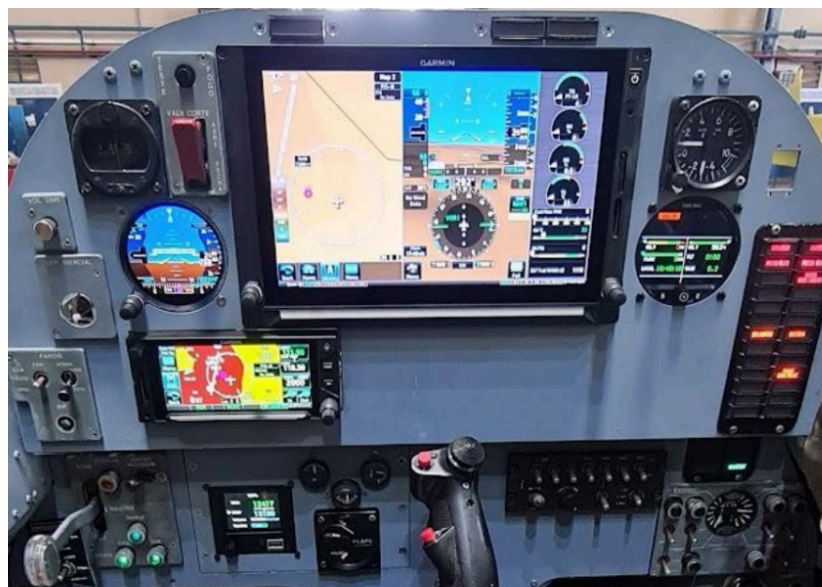
Figura 4 Novo painel do T-27M Tucano
