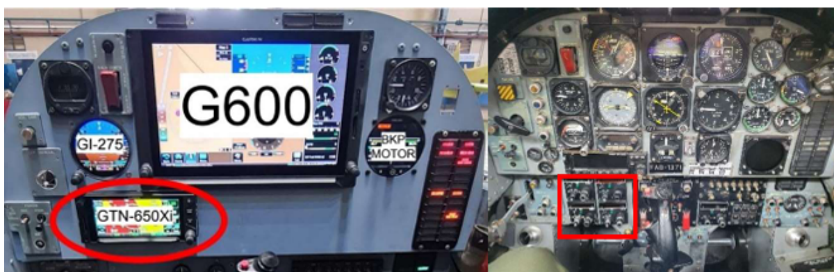
Figura 6 Comparativo painel de rádio e navegação T-27M e T-27
