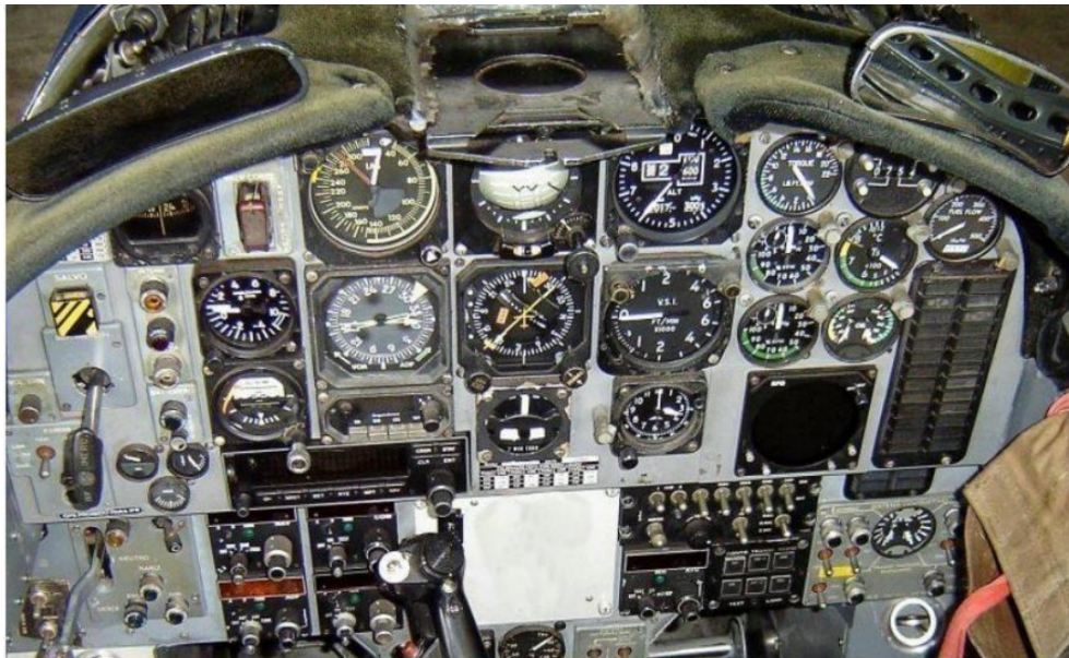
Figura 1 Painel analógico da versão convencional do T-27
