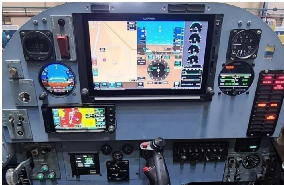
Figura 2 Painel modernizado do T-27M
