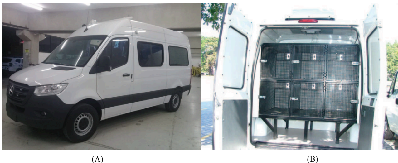
Figura 17 Viatura com 06 boxes de cães e sistema de refrigeração umidificado, (A) vista externa, (B) vista interna
