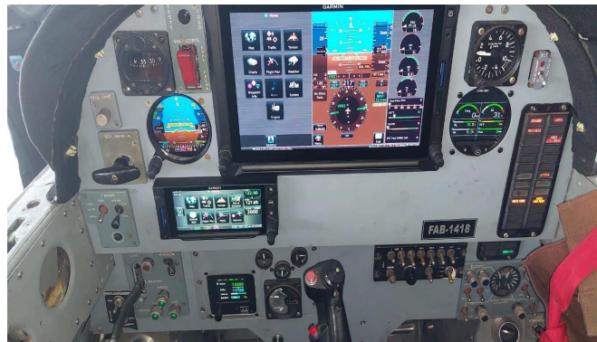
Figura 2 Painel de instrumentos do modelo modernizado ( glass cockpit ) Fonte: Força Aérea Brasileira, 2021.
