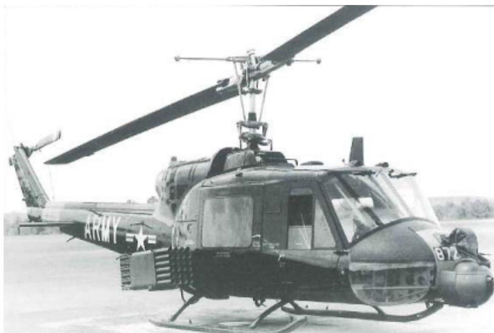
Figura 8 UH-1B armado com rocket pods e lançador de granadas
