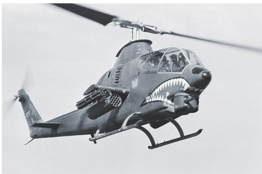
Figura 9 AH-1G Cobra com pintura de boca de tubarão, armado com foguetes de 70mm, rocket pods , minigun calibre 7,62mm e lançador automático de granadas de 40mm
