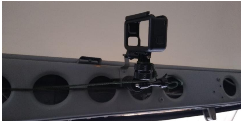
Figura 5 – Suporte fixado com ancoragem de segurança
