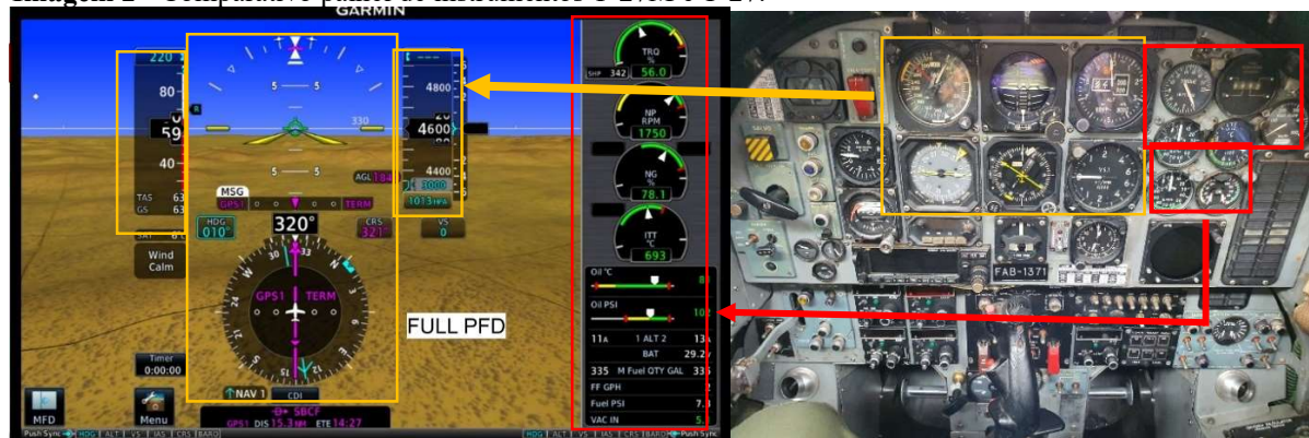
Imagem 2 - Comparativo painel de instrumentos T-27M e T-27.
