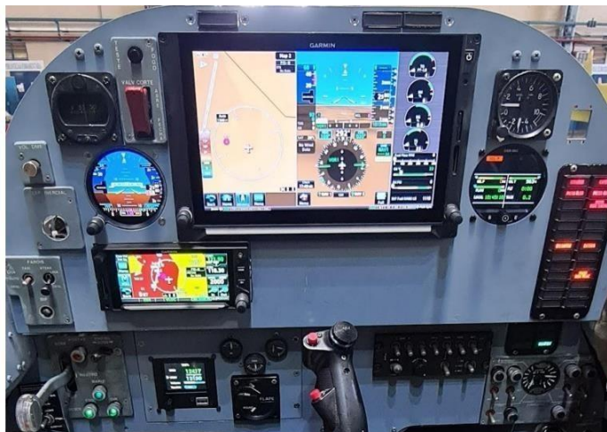
Figura 2 Painel do T-27 após a modernização
