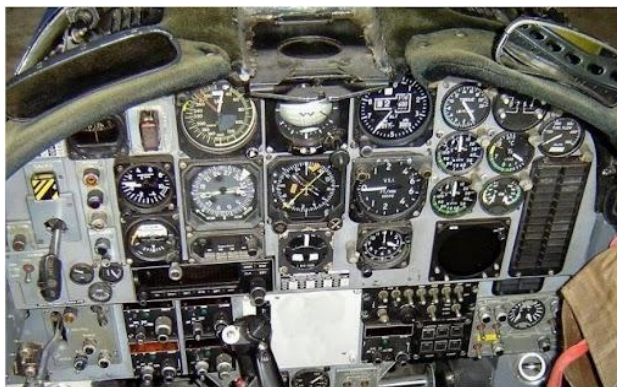
Figura 1 Painel do T-27 antes da modernização
