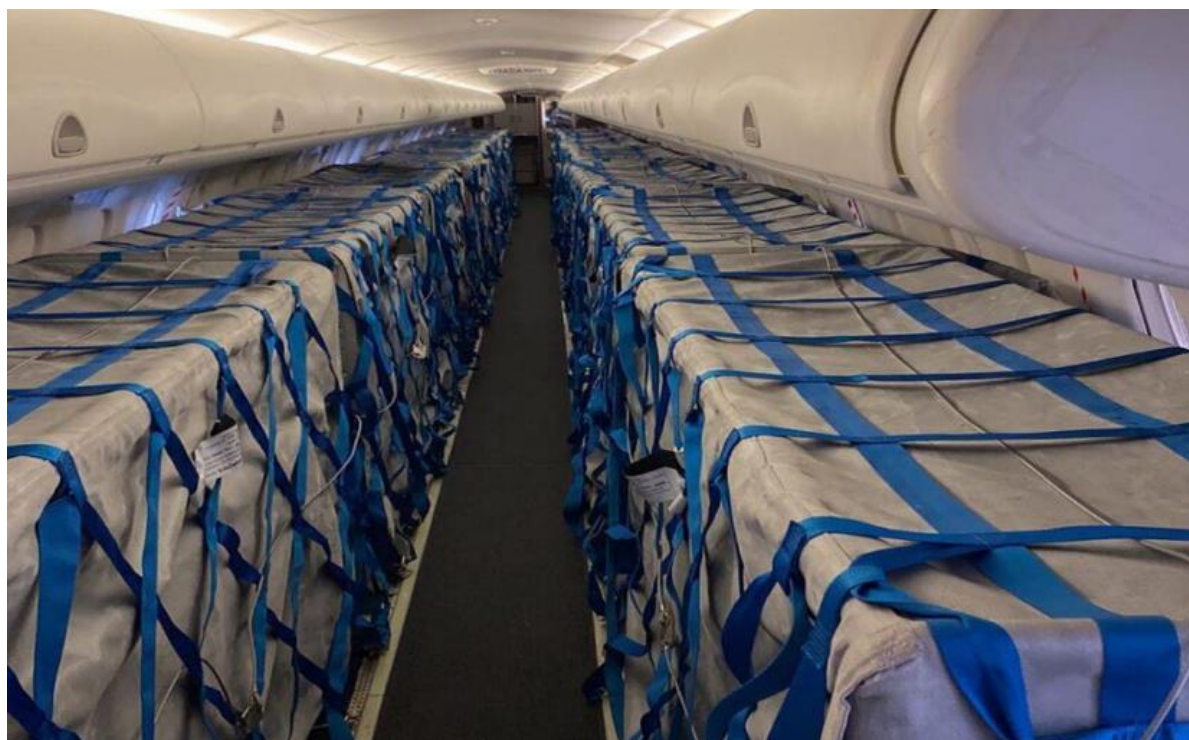
Figura 5 Embraer E195 da Azul Linhas Aéreas modificado para a classe F
