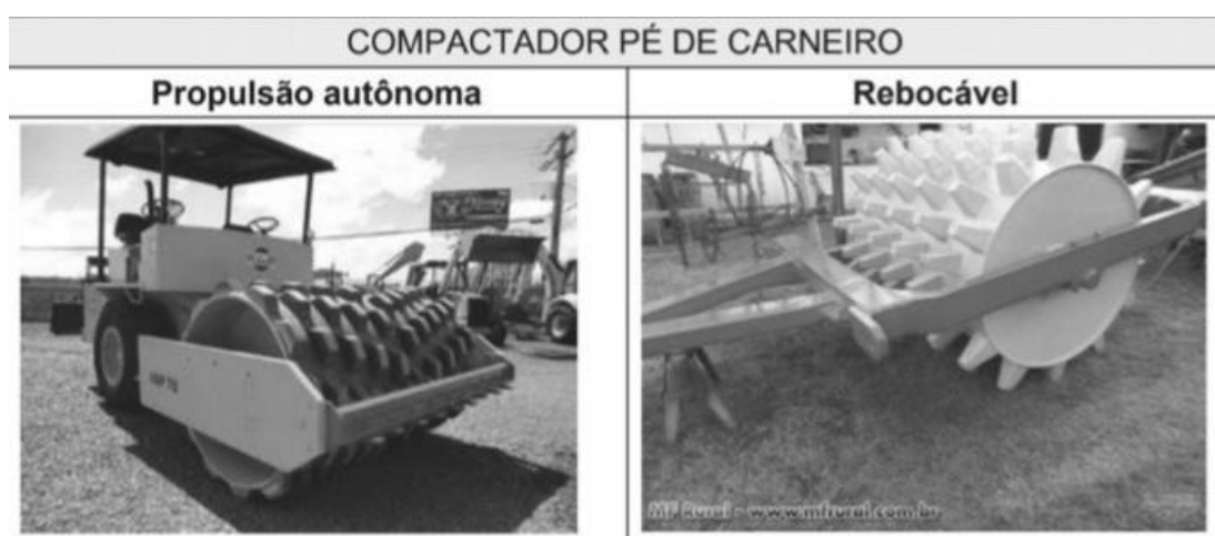
Figura 3. Dois tipos de maquinários distintos (propulsão autônoma e rebocável).
