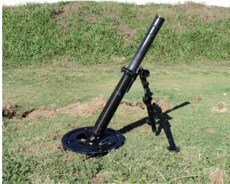
Figura 4 Morteiro Médio Antecarga (Mrt Me A Cg) 81 mm
