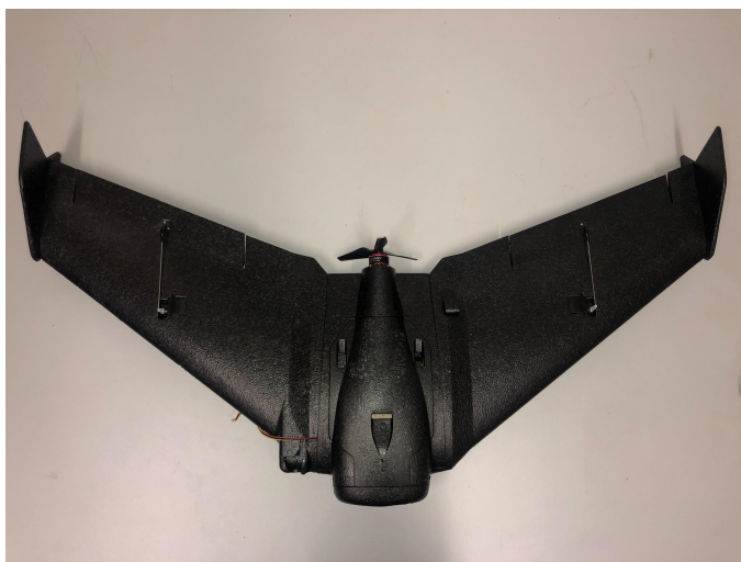
Figura 2 Estrutura básica da zagi, com o motor instalado
