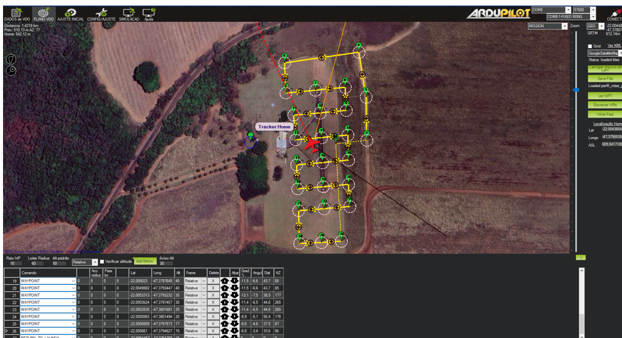
Figura 18 Plano de voo no perfil de rotas paralelas utilizado no voo automático da Zagi
