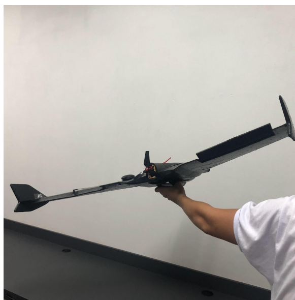
Figura 16 Zagi comandando automaticamente rolamento para a direita, após perceber rolamento inadvertido à esquerda, em teste do piloto automático no solo
