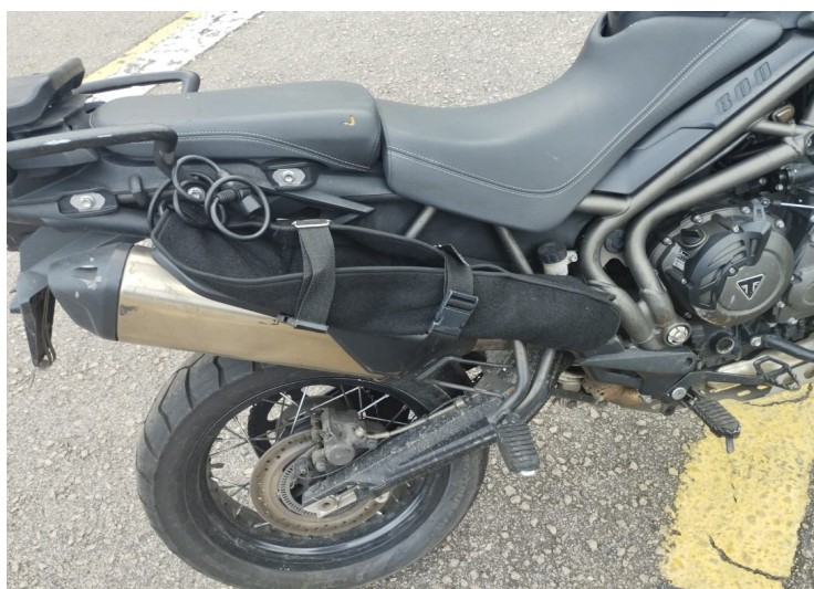
Figura 2 adaptação para fuzil para moto Triumph Tiger 1200
