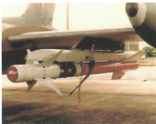
Figura 4: AT-26 Xavante do CTA equipado com um MAA-1 Piranha no lançador LAU-7, padrão Sidewinder durante a Operação Piranha V em Natal (20/07/96).
