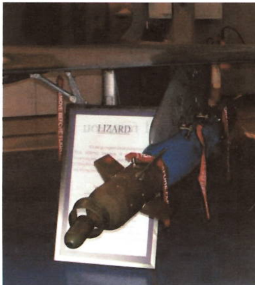
Figura 8: Uma bomba guiada a laser Lizard no cabide interno de um F-5EM Fonte: http://sistemadearmas.sites.uol.com.br
