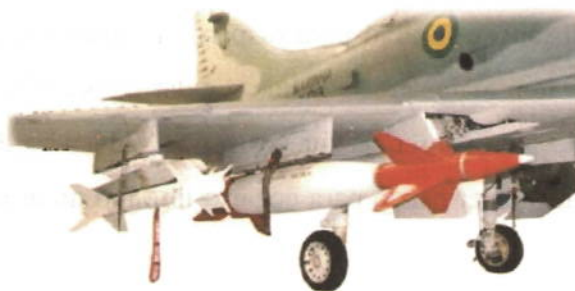
Figura 13: Simulação de uma bomba com kit de guiamento nacional na aeronave Fonte: Site do IAE/DCTA http://www.iae.cta.br
