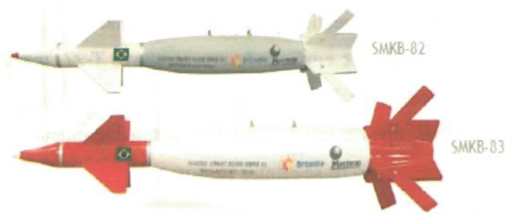
Figura 12: Simulação de como ficaram as bombas Mk-82 (500 lbs) e Mk-83 (1.000 lbs) com o kit de guiamento brasileiro
