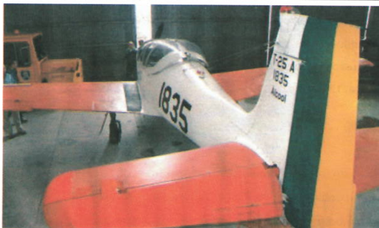
FIGURA 6 - Avião T-25 Universal equipado com motor a álcool Fonte: CTA
