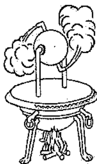
FIGURA 2 – Eolipila de Hero
