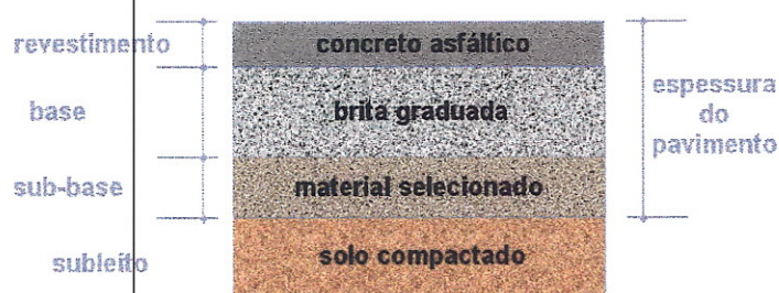
Figura 3: Estrutura de pavimento flexível Fonte: DIRENG
