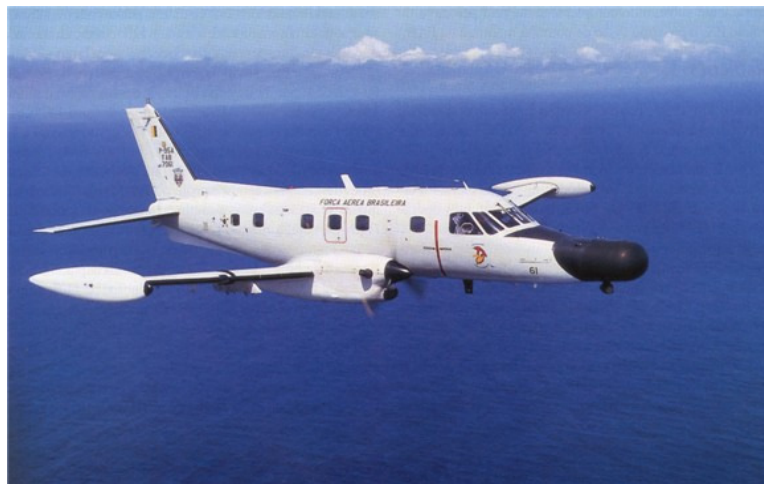
Figura 18: Aeronave Bandeirante Patrulha. Os tanques de combustível nas pontas das asas aumentam a autonomia; o radar de busca está no compartimento do “nariz” da aeronave; sob esse “nariz”, pode ser visto o equipamento detector de sinais.
