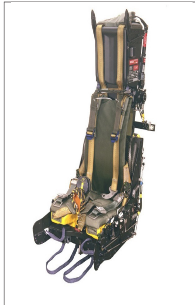
Figura 4 – Conjunto completo do assento Ejetor Martin Baker®.
